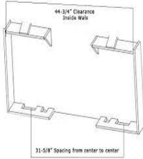
Comme tous les accessoires de type Skid Steer, l'installation est très simple. L'attache est composée de plaques supérieures en angle et trous rectangulaire sur le bas. Assurez-vous que les composants du tracteur et de l'ensemble de fourches et pics soient propres et exempt de boue, pierre, branches et autres. Ceci nuirait au bon fonctionnement de l'équipement et peut s'avérer dangereux.
